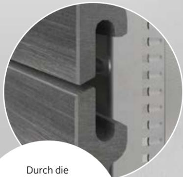
Durch die Ausbildung der 4 mm schmalen Fugen dringt nur sehr wenig Wasser in die Fassade. Die Konstruktion ist damit vor Schlagregen geschützt.
